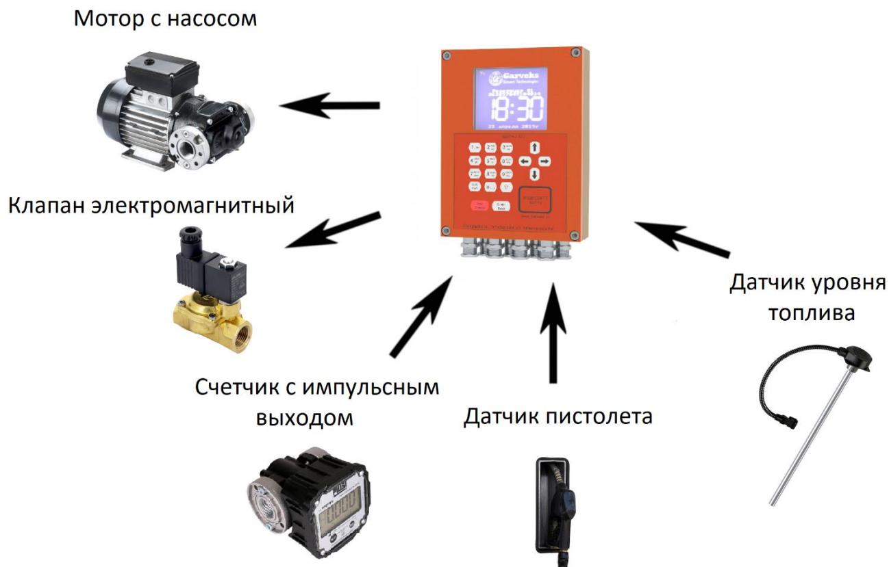
Рисунок 2: Конфигурация оборудования для одного поста
